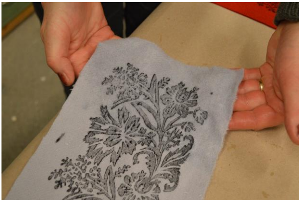
Det blå stoffet ble fuktet og gnidd. Dette ga et dårligere resultat. Det blå stoffet var av en annen kvalitet og egnet seg også dårligere til trykking.
