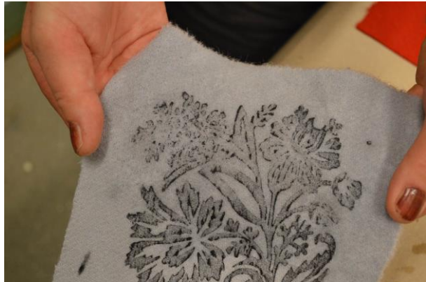
Det blå stoffet ble fuktet og gnidd. Dette ga et dårligere resultat. Det blå stoffet var av en annen kvalitet og egnet seg også dårligere til trykking.
